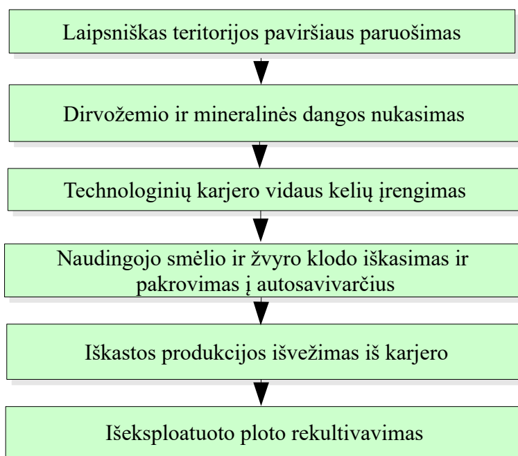
1 pav. Žvyro karjero eksploatavimo technologija
